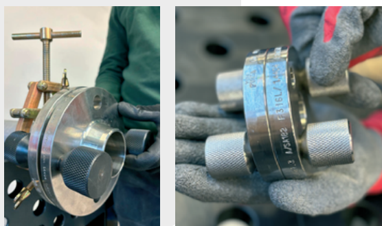
Esempi applicativi perni per flangia in acciaio INOX
