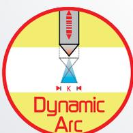
La funzione consente di mantenere costante il prodotto Tensione x Corrente. Il generatore aumenta la corrente di saldatura al diminuire della tensione d'arco e diminuisce il valore di corrente di saldatura se la tensione d'arco aumenta. Il valore di **DynARC** si può regolare da un minimo di 10Ampere ad un massimo di 50Ampere ad ogni variazione di 1Volt sia essa positiva o negativa.
